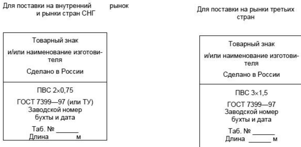
Рисунок А.3 - Расположение маркировки на ярлыке, прикрепленном к бухте, катушке или барабану
